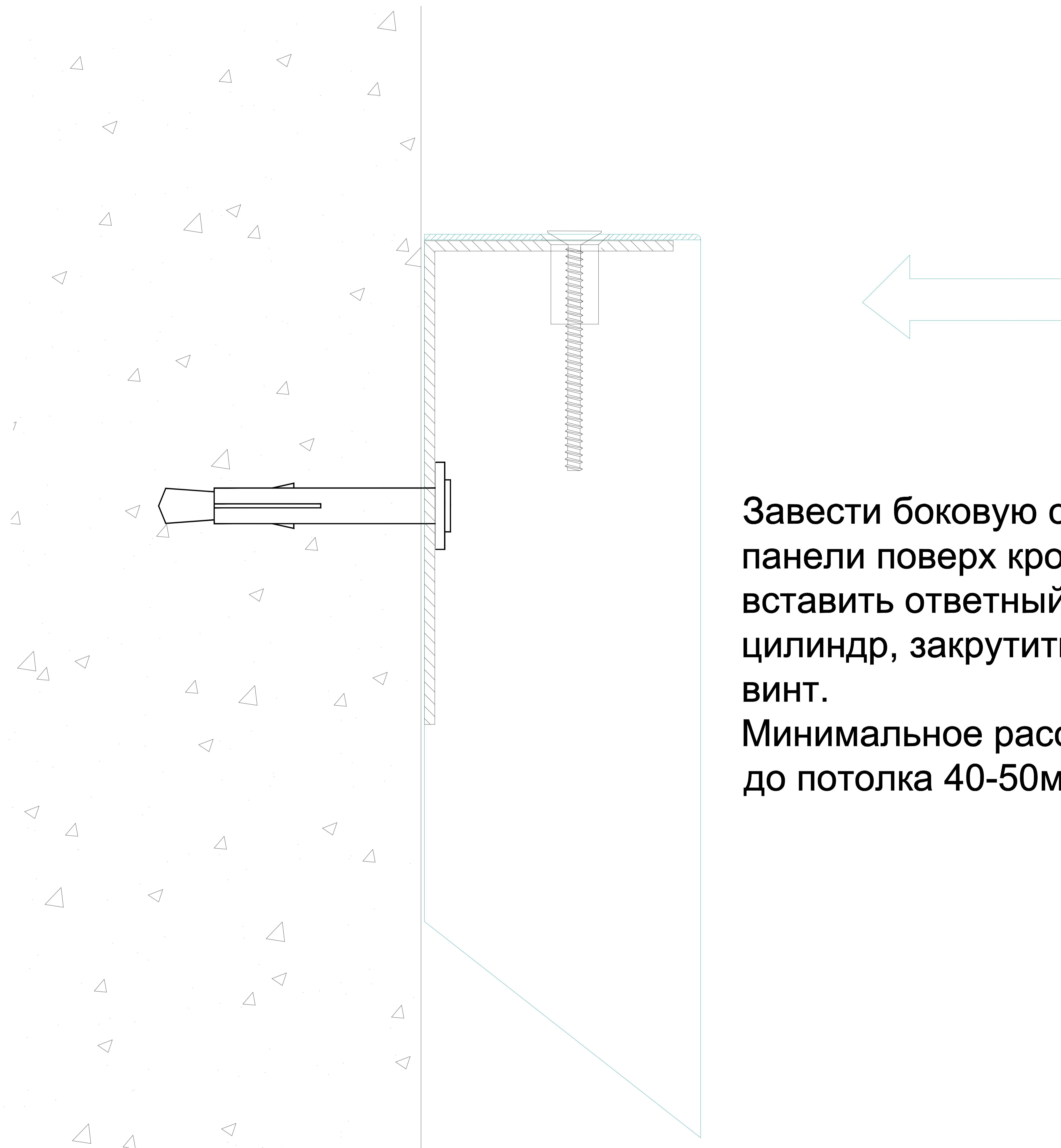
Завести боковую сторону панели поверх кронштейна, вставить ответный цилиндр, закрутить в него винт.
