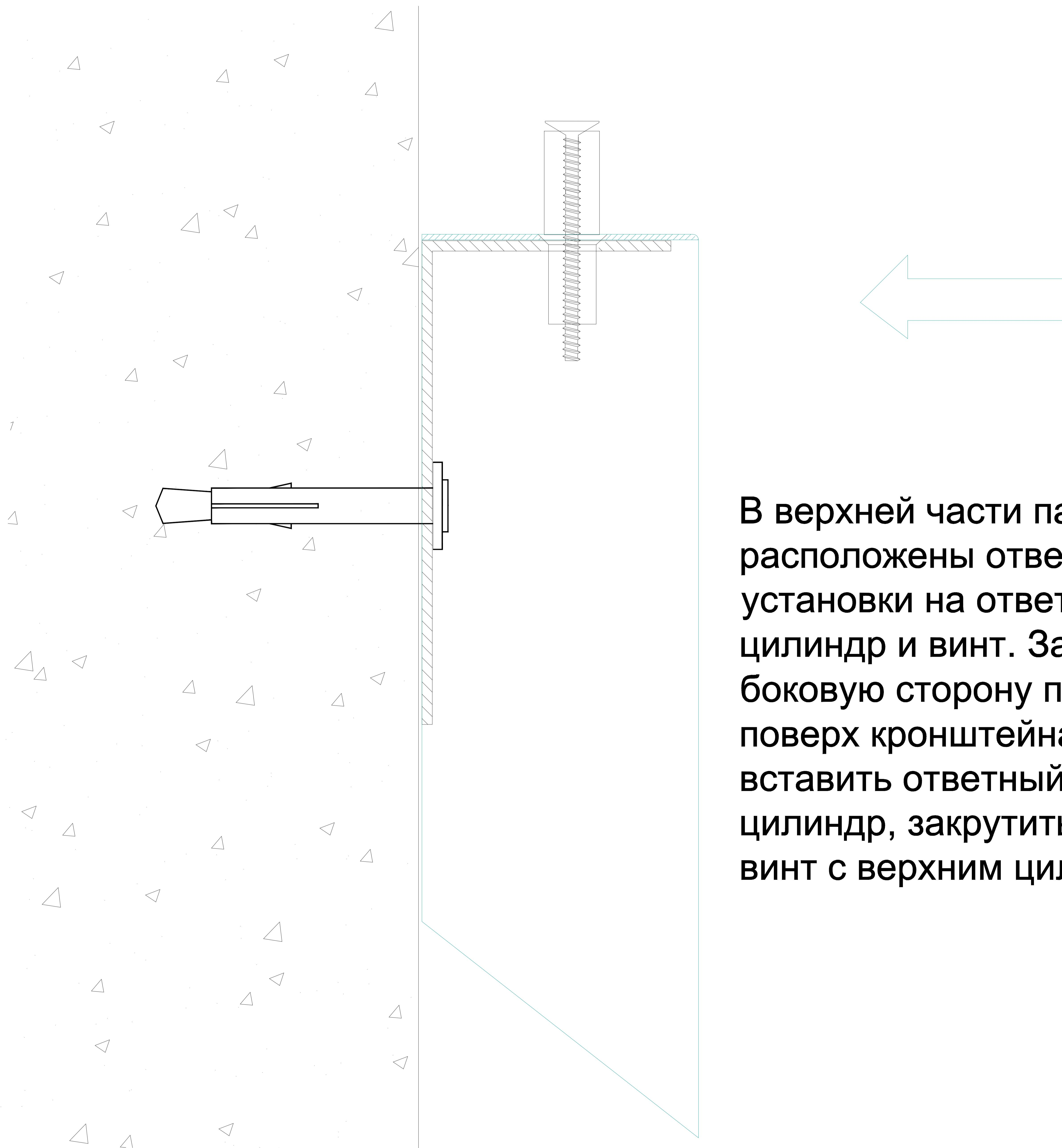
В верхней части панели расположены отверстия для установки на ответный цилиндр и винт. Завести боковую сторону панели поверх кронштейна, вставить ответный цилиндр, закрутить в него винт с верхним цилиндром.
